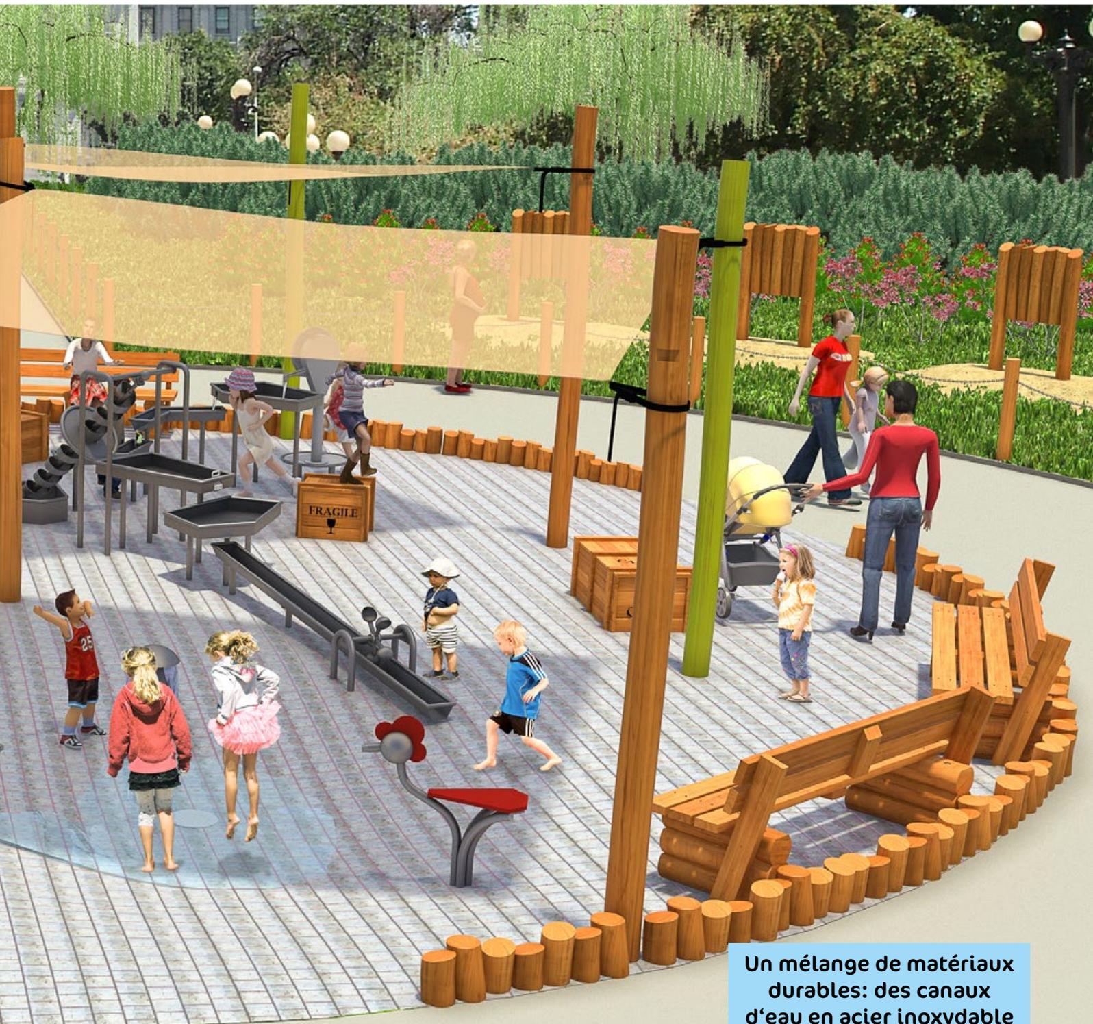
Un mélange de matériaux durables: des canaux d'eau en acier inoxydable en combinaison avec du bois de robinier.
